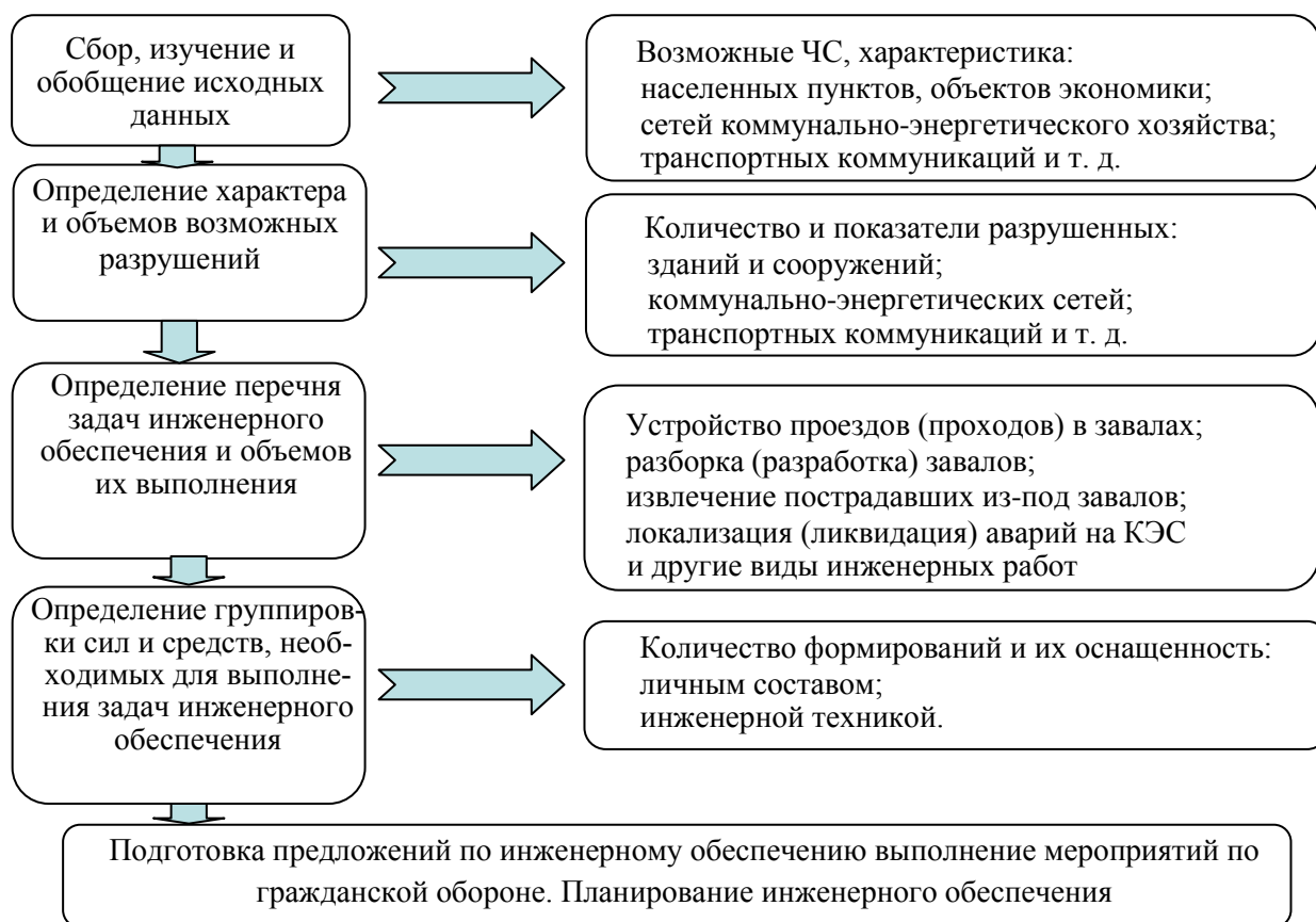
Рис. 3.6.1 – Последовательность прогнозирования инженерной обстановки
